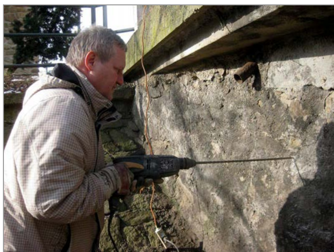
foto 18: Ověřování tloušťky kamenného zdiva čela mostu
