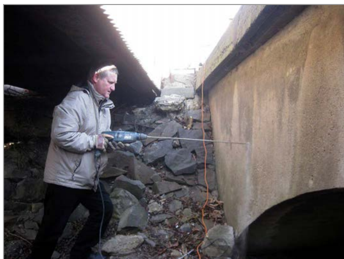
foto 20: Ověřování tloušťky ŽB čela mostu
